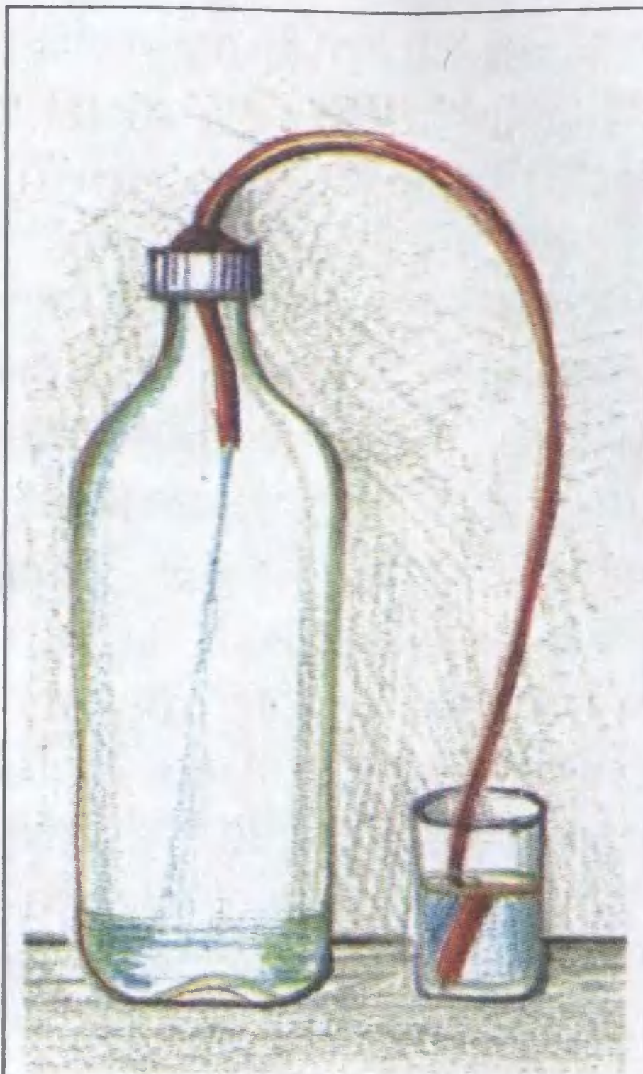
Рис. 3. Охлажденная бутылка способна поднимать воду на значительную высоту.
